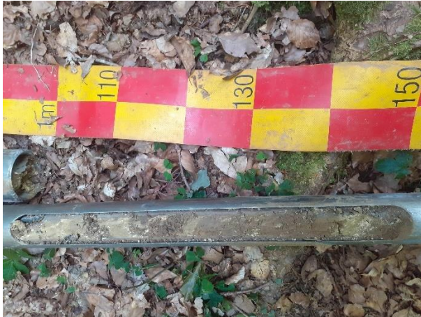
Abbildung 3-3: Kalkkonkretionen im Bt-Sd-Horizont der Sondierung 2
