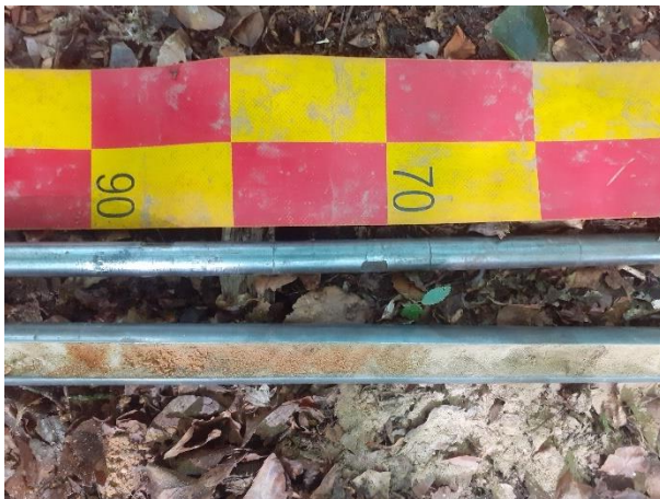
Abbildung 3-1: Redox-Merkmale im Bt-Horizont der Sondierung 1, ein Teil der Rotfärbung könnte auch auf Hämatit-Bildung im Tertiär (tropische Verwitterung) zurückzuführen sein
